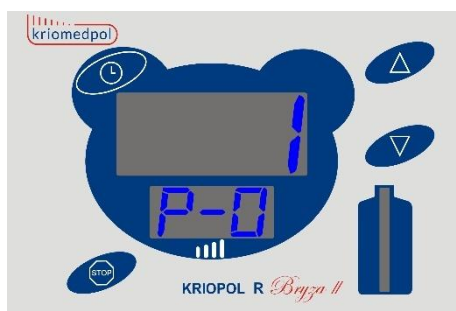
Rys. 7 Menu ustawień dodatkowych (widoczny parametr P-0, wartość 1).
