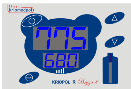
Rys. 6 Korekta ustawienia wskazania górnego (wartość aktualna 775, wartość zapamiętana 680).
